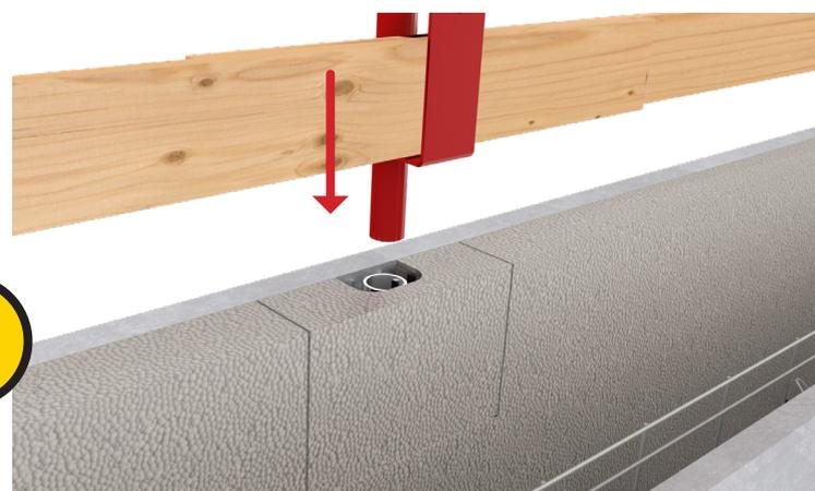
Disposez votre tube de garde-corps à l'aplomb du fourreau et insérez-le jusqu'au fond.
