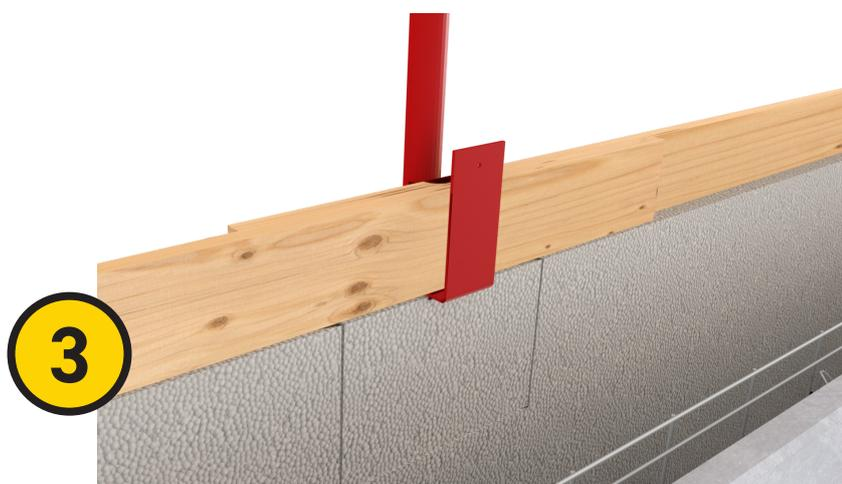
L'adaptateur est attaché au fourreau. Votre garde-corps est en place et va vous permettre de travailler en toute sécurité.
