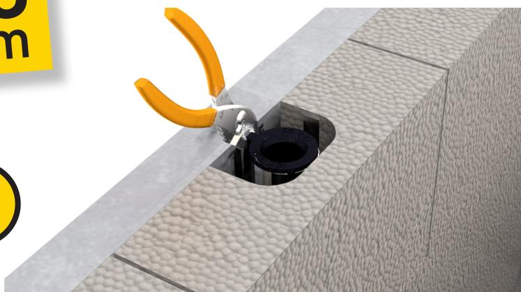
Le fourreau intégré SPURGIN est composé d'un tube solidaire du mur et d'un adaptateur noir intégré dans le tube. Pour que le tube de garde-corps de 40 mm s'intègre parfaitement au fourreau, vous devez retirer l'adaptateur.
