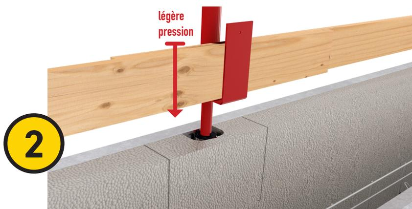
... le tube de votre garde-corps de 25 mm de diamètre s'emboîte dans l'adaptateur contenu par le fourreau en exerçant une légère pression jusqu'à ce que la membrane noire se déchire et laisse passer l'intégralité du tube.
