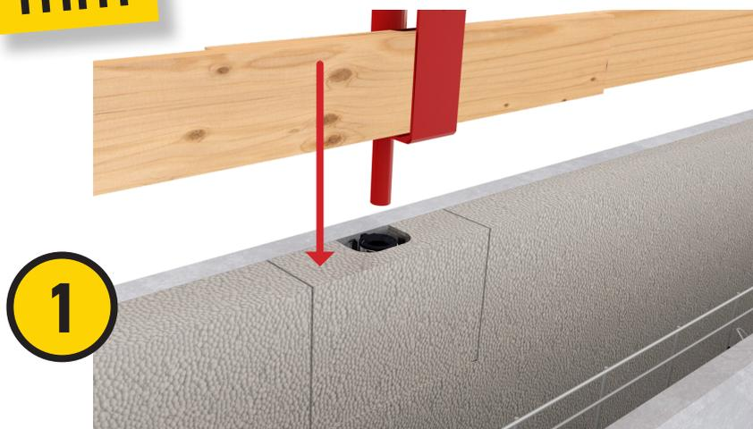
Le fourreau intégré SPURGIN est composé d'un tube solidaire du mur et d'un adaptateur noir intégré dans le tube. Disposez votre tube de garde-corps à l'aplomb du fourreau...
