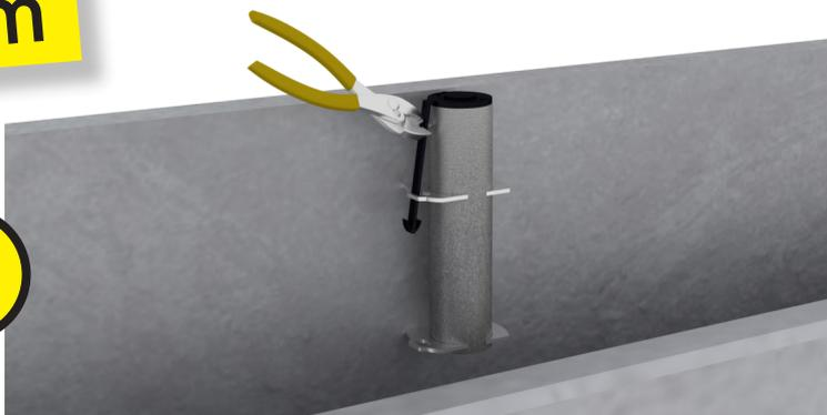
Le fourreau intégré SPURGIN est composé d'un tube solidaire du mur et d'un adaptateur noir intégré dans le tube. Pour que le tube de garde-corps de 40 mm s'intègre parfaitement au fourreau, vous devez retirer l'adaptateur.
