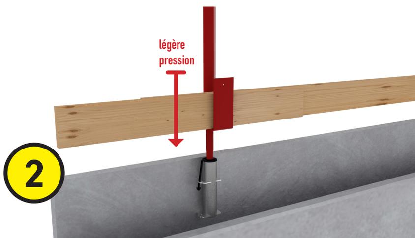
... le tube de votre garde-corps de 25 mm de diamètre s'emboîte dans l'adaptateur contenu par le fourreau en exerçant une légère pression jusqu'à ce que la membrane noire se déchire et laisse passer l'intégralité du tube.
