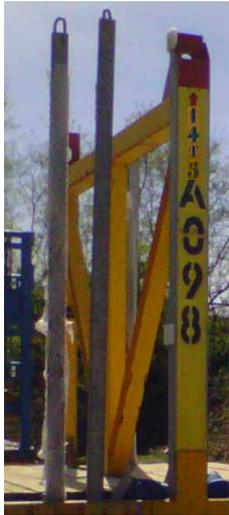
Ces poteaux permettent de maintenir les Prémurs verticaux, et légèrement espacés les uns des autres. Ainsi, il est possible de décharger les Prémurs indépendamment les uns des autres.
