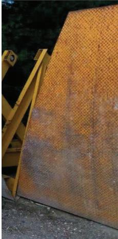
L'ensemble de la surface du Retourneur venant en contact avec le sol est muni d'un relief directement imprimé dans la plaque acier.
