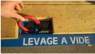
Chaque Rack est équipé de quatre anneaux de levage à vide. Il est clairement spécifié, sur chaque zone comportant ces anneaux «levage à vide uniquement ».
