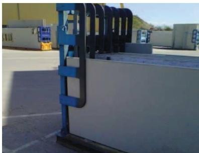
Les flasques de maintien sont des éléments métalliques rigides, plastifiées en about, venant en contact des Prémurs lorsque ces derniers sont stockés dans le Rack.
