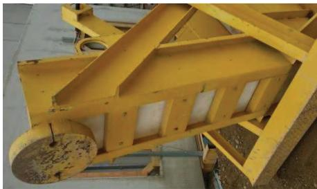
Les Retourneurs Spurgin sont équipés d'un contrepoids circulaire de 40 cm de diamètre et 8 cm d'épaisseur en acier plein.
