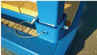
En complément de la sécurité apportée par la présence des sabots anti-déchaussement, une goupille de sécurité vient compléter le dispositif anti-déchaussement. Cette goupille traverse de part en part le sabot anti-déchaussement et le pied de l'échelle, dans les perçages spécifiquement prévus.
