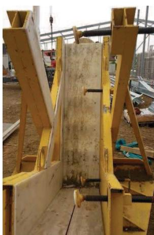
Les Retourneurs Spurgin sont équipés de vis de guidage, solidaires d'une part d'un manche de préhension large et robuste, et d'autre part, d'une platine circulaire équipée d'une plaquette de contact en téflon.
