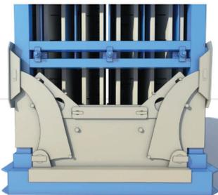
Les patins de stabilité équipant les Racks Spurgin vous garantissent la bonne tenue des Racks vis-à-vis des actions horizontales définies dans le guide de l'INRS ED 6118 – « Murs à coffrage intégré (MCI) – Prescriptions minimales à intégrer à la conception du procédé constructif MCI pour une mise en œuvre en sécurité ».
