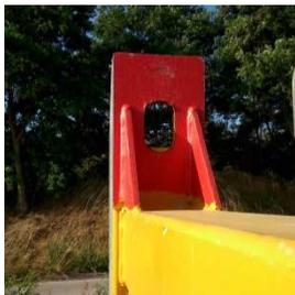
Chaque Box est équipé de deux anneaux de levage à plein. Ces anneaux sont situés en partie haute, aux deux extrémités de la potence centrale. Ces deux points sont les seuls et uniques points permettant de lever le Box à plein. En aucun cas un Box plein ne doit être manutentionné par d'autres points.
