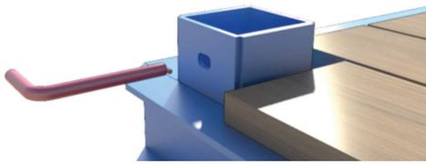
L'échelle est mise en place par insertion de ses deux pieds dans les sabots anti-déchaussement.
