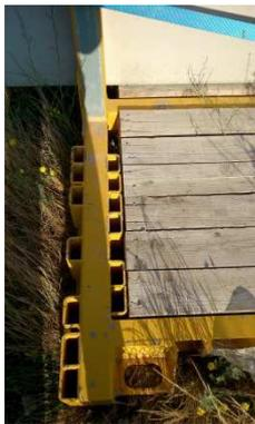
Afin de régler avec finesse l'espacement entre poteaux, les Racks Spurgin sont équipés, à chaque about, de deux rangées de sabots, placés en quinconce, afin de donner une plage de réglage la plus importante possible.
