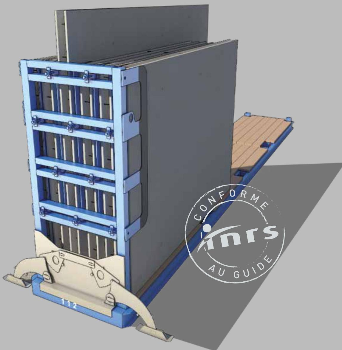
Élément de Transport et de Stockage : RACK SPURGIN (ETS)
