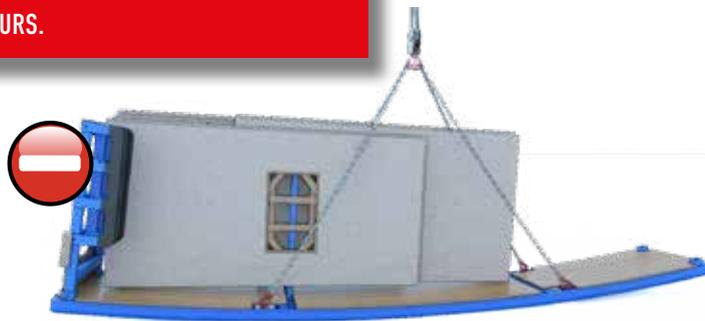
**INTERDICTION** de déplacer un RACK avec un engin de chantier, qu'il soit vide ou plein.
