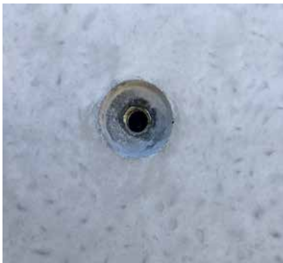
1- Nettoyer l'intérieur de la douille.
