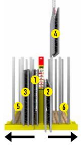
Charger en alternance les Prémurs d'un côté et de l'autre en partant de l'intérieur vers l'extérieur Respectez l'ordre de 1 à 6.
