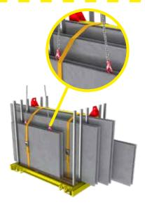
Pour les Prémurs inférieurs à 3 m. de longueur, mettre en tension avant de désangler
