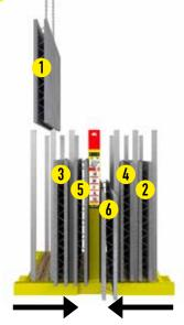
Décharger en alternance les Prémurs d'un côté et de l'autre en partant de l'extérieur vers l'intérieur. Respectez l'ordre de 1 à 6.
