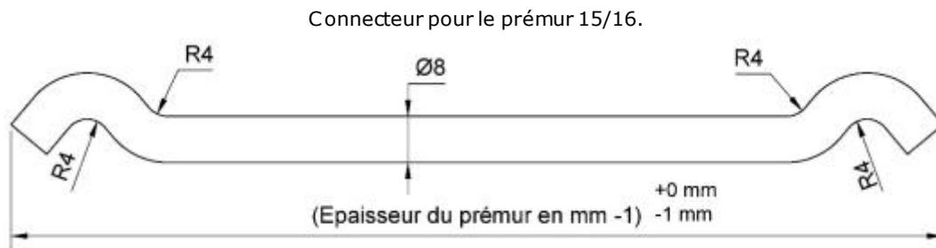
**Figure A. 2 : Géométrie des connecteurs métalliques**
