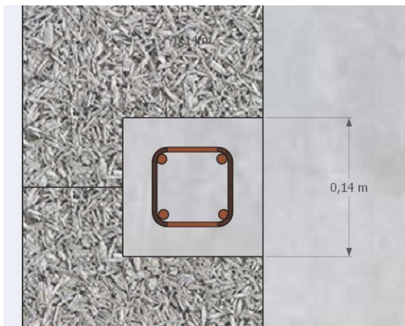
Figure A10 : Vue de principe des armatures de chaînages verticaux et horizontaux
