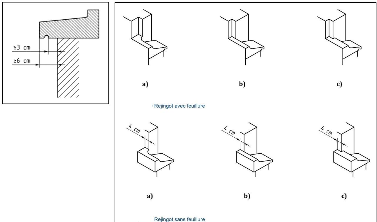
Figure A34 : Intégration des coffres et demi-coffres de volets roulants
