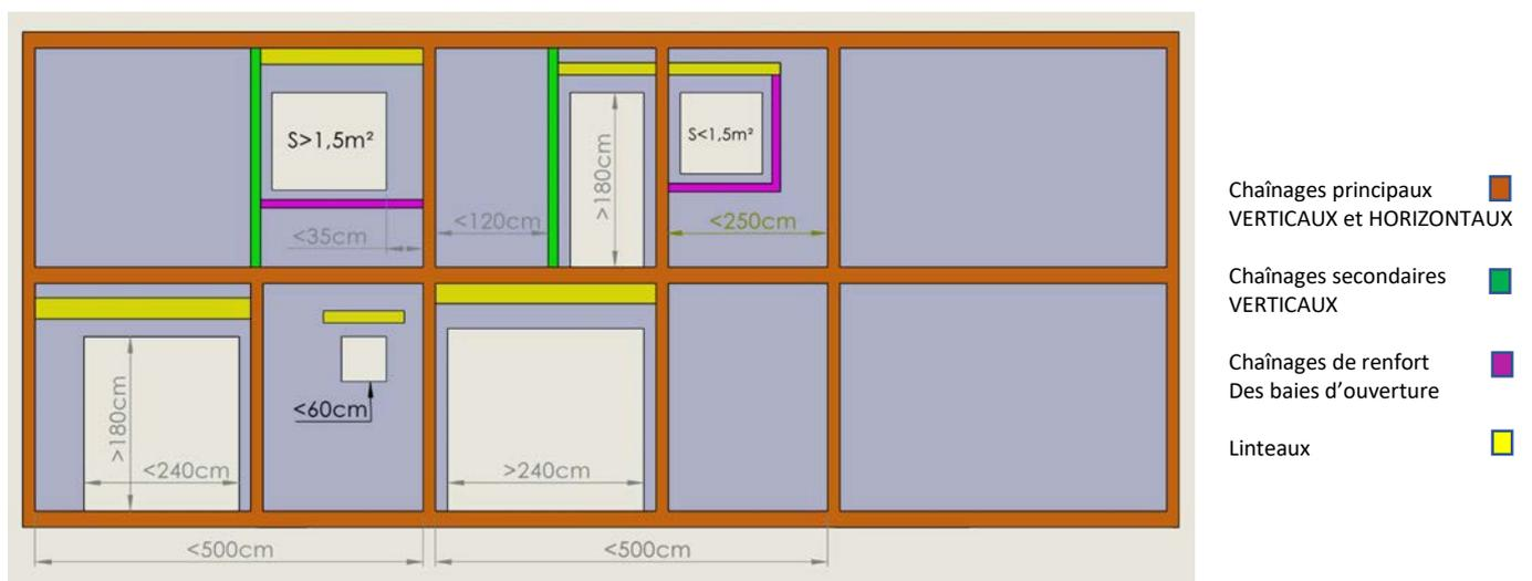
Figure A29 : Dispositions de principe des chaînages pour les configurations D, E et F – hors analyse de structure ou exigences particulières :
