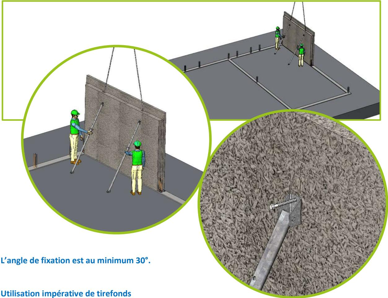
L'angle de fixation est au minimum 30°.
