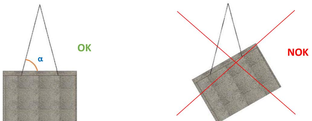
L'élingage doit être équilibré. L'angle minimum d'élingage  $\alpha = 60^\circ$  et les longueurs des élingues adaptées pour respecter l'angle minimum. Une longueur d'élingue  $L$ , correspondant à la longueur  $L$  du panneau, permet de garantir un angle minimum de  $60^\circ$ .
