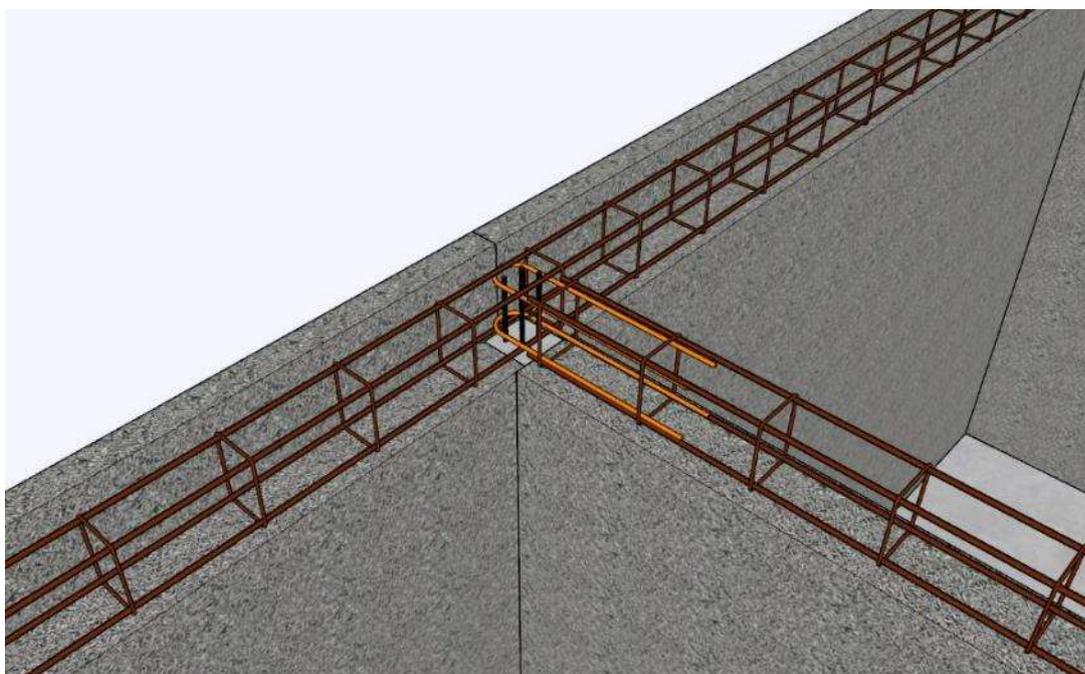
Figure A16 : Continuité des armatures de chaînages horizontaux avec équerres- angle
