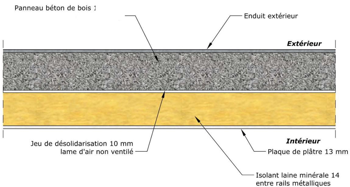
Figures A40 : Exemple partie courante Panneau avec bardages
