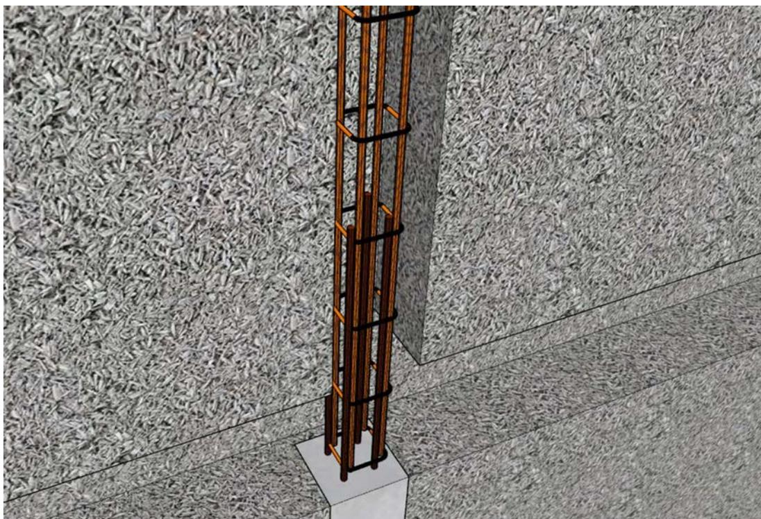
Recouvrement : 60  $\emptyset$  en zone sismique et 50  $\emptyset$  en zone non sismique
