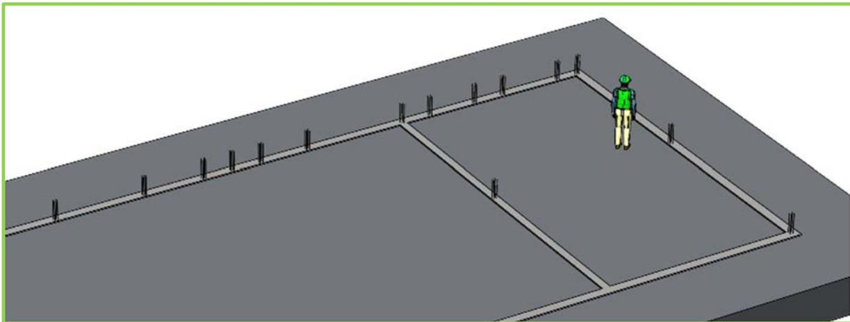
Contrôle des caractéristiques et du positionnement des armatures en attentes.
