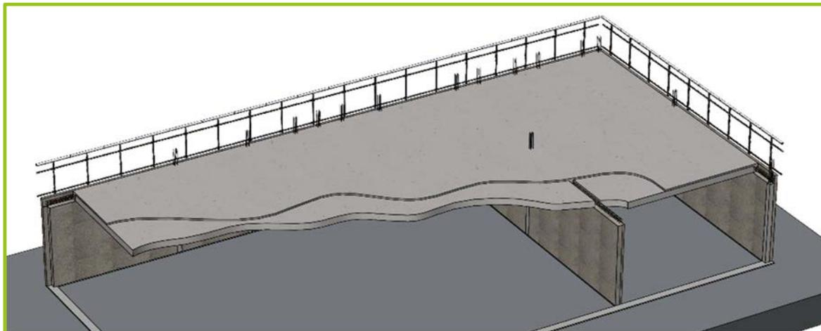
Le coulage se fait depuis le plancher haut avec le béton spécifié dans les plans de coffrage / ferrailage du BET.
