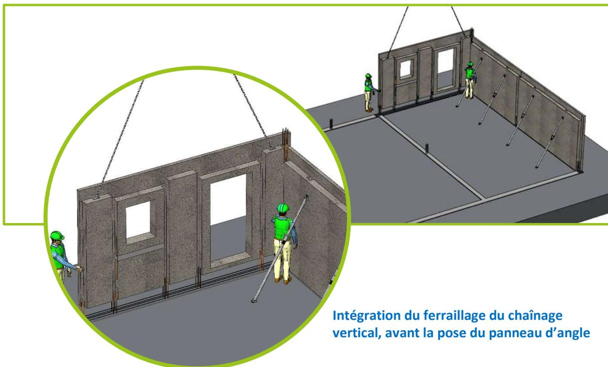
**Intégration du ferrillage du chaînage vertical, avant la pose du panneau d'angle**
