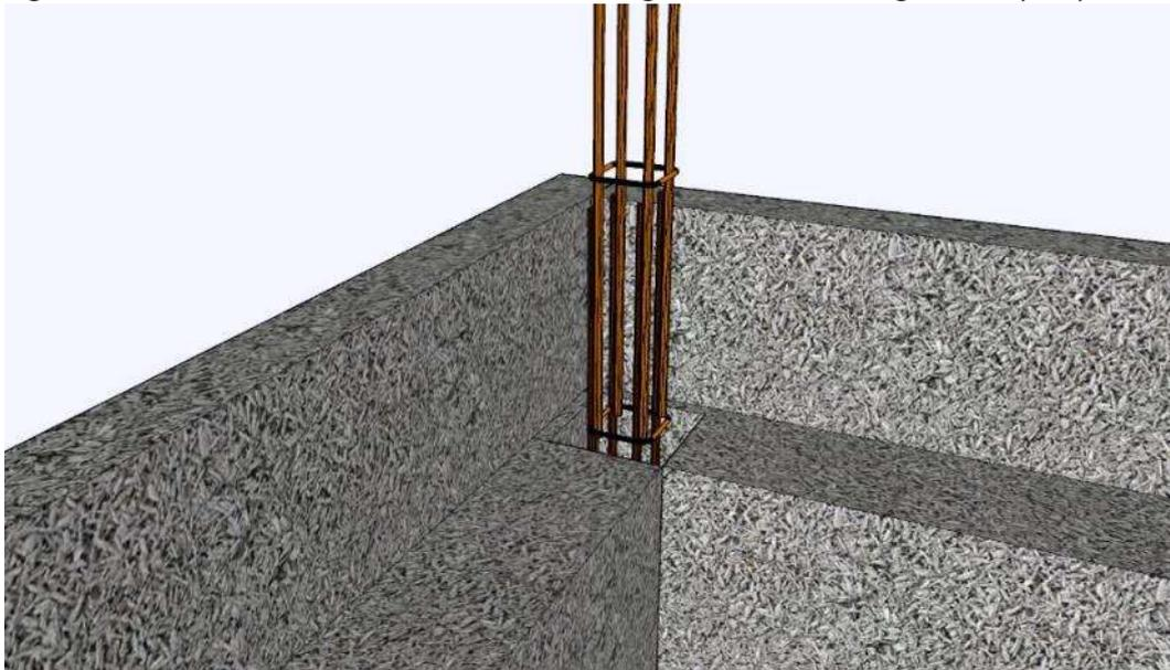
Figure A13 : Continuité des armatures de chaînages horizontaux avec boucles U - angle
