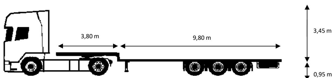
Les dimensions des boxes sont en largeur environ 2,40 m et en longueur 2,40 m à 3,00m. Leur poids à vide varie de 1 Tonne à environ 1,5 Tonne et la charge maximale admissible est de 20 Tonnes. Les boxes sont acheminées sur remorque plateau ou surbaissée. En fonction de la dimension en longueur des panneaux, jusqu'à 4 boxes peuvent être ainsi livrés sur le même camion. Les panneaux sont sanglés au box afin d'éviter les chutes.
