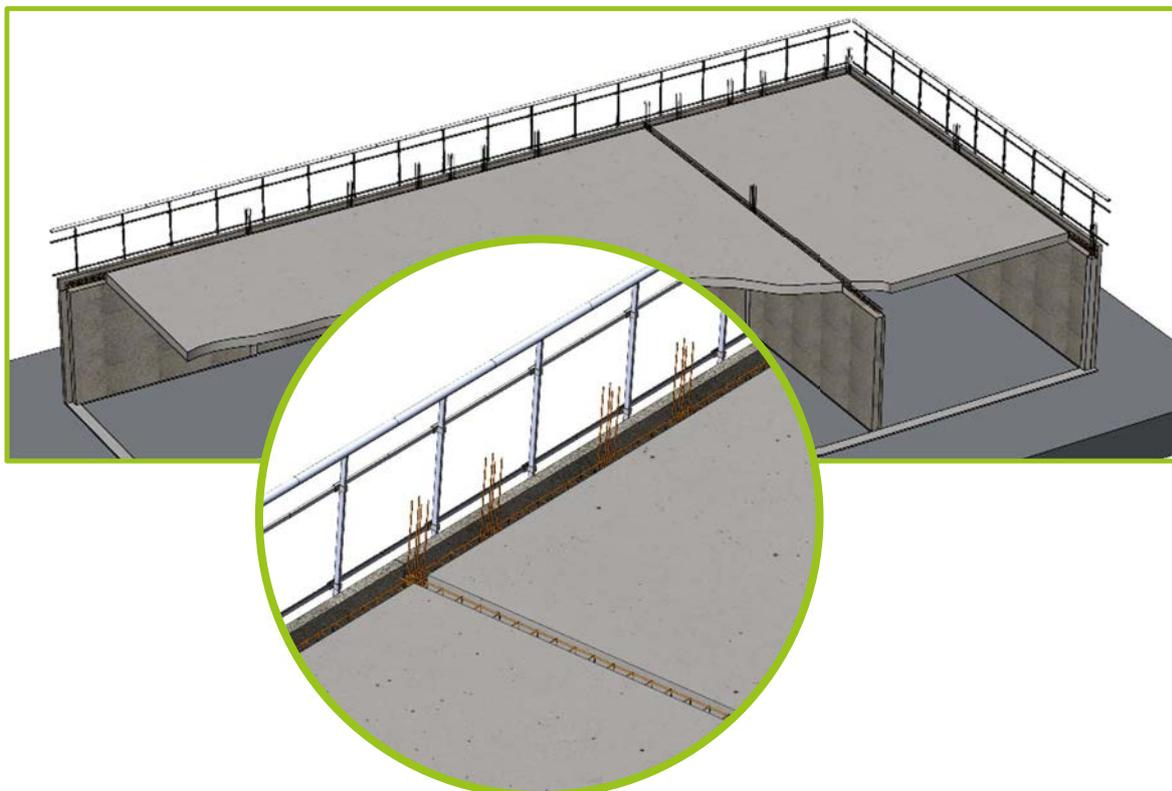
Les armatures de chaînages / poutres sont mises en place selon le plan de ferrailage du BET et en veillant à bien positionner les armatures de liaison nécessaires.
