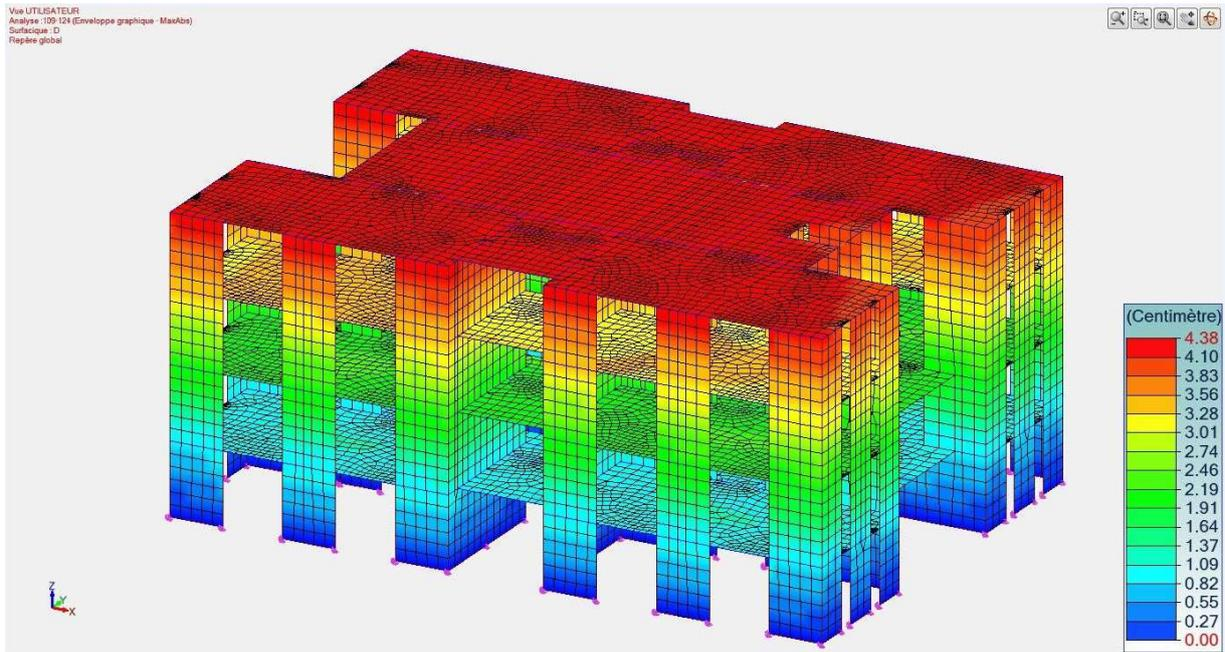
Fig. 10 – Modèle béton de bois CS2 – Déformée globale D
