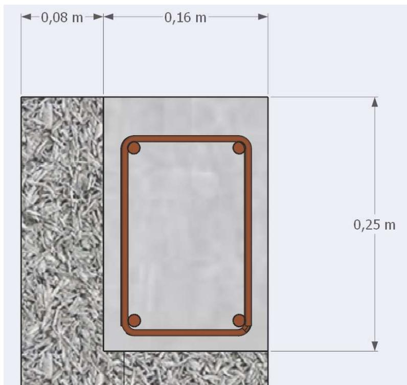
Figure A09 : Vue de principe en coupe d'un chaînage vertical Principal
