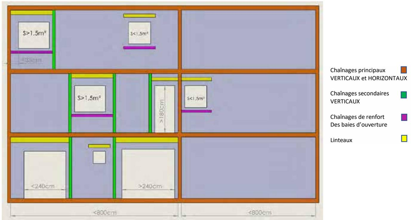
Figure A28 : Dispositions de principe des chaînages pour les configurations B et C, zones sismiques 3 et 4 – hors analyse de structure :
