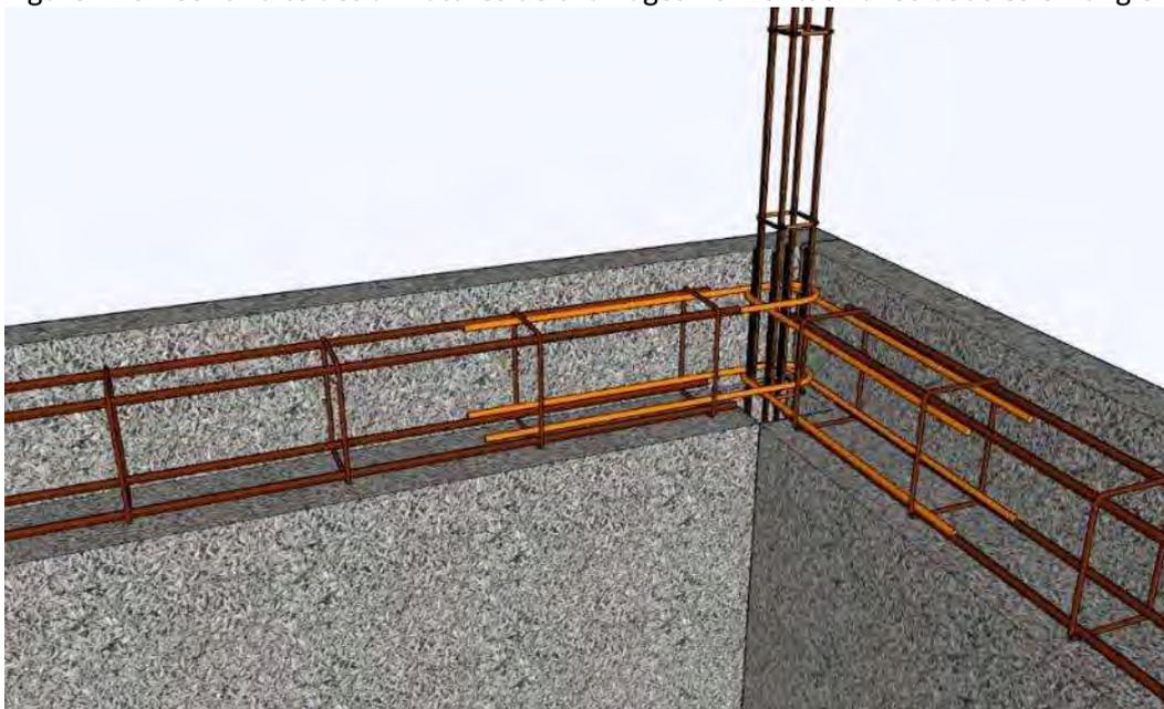
Figure A14 : Continuité des armatures de chaînages horizontaux avec boucles U – Liaison refend
