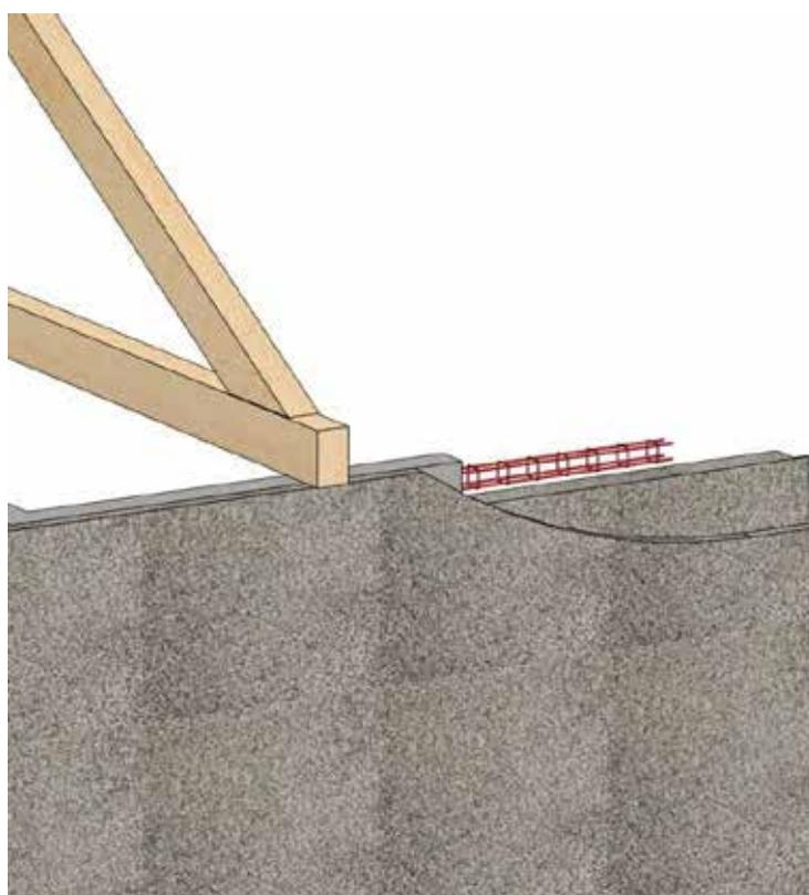
Semelle d'appui des fermes : chaînage de couronnement ou insert d'une semelle de largeur suffisante.
