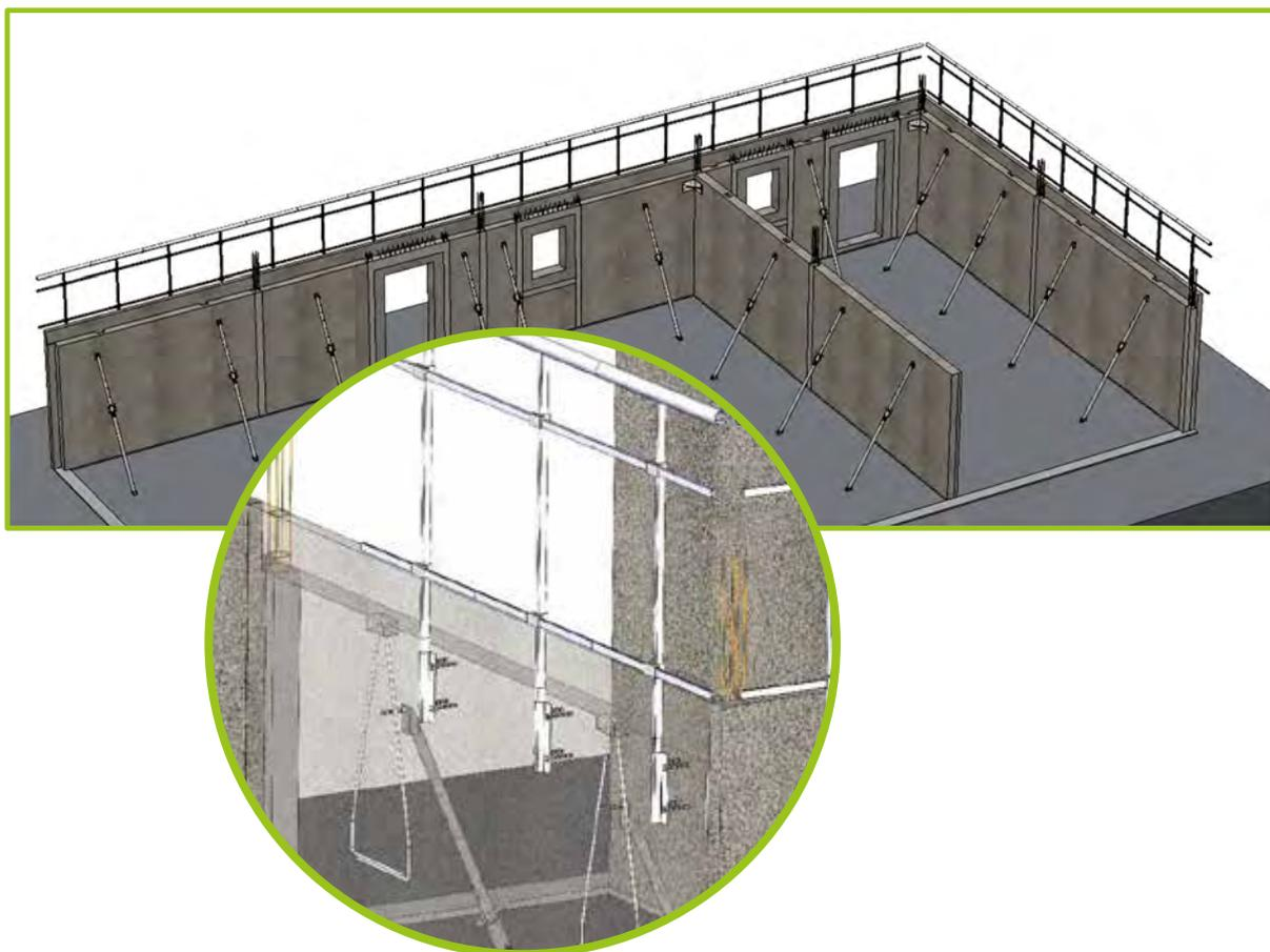
Les garde-corps de sécurité sont fixés directement sur les murs TimberRoc sur l'extérieur. Fixer les platines de fixation des garde-corps au-dessous du niveau des planelles intégrées.
