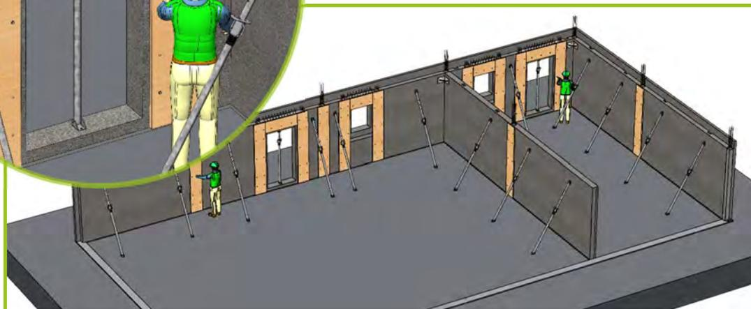
Les réservations sont fermées par des planches de coffrage, préalablement huilées sur la face intérieure. Les planches sont directement fixées par vissage dans le béton de bois à raison de minimum 4 vis M10\*120 par côté sur la hauteur d'un panneau de 3 m.
