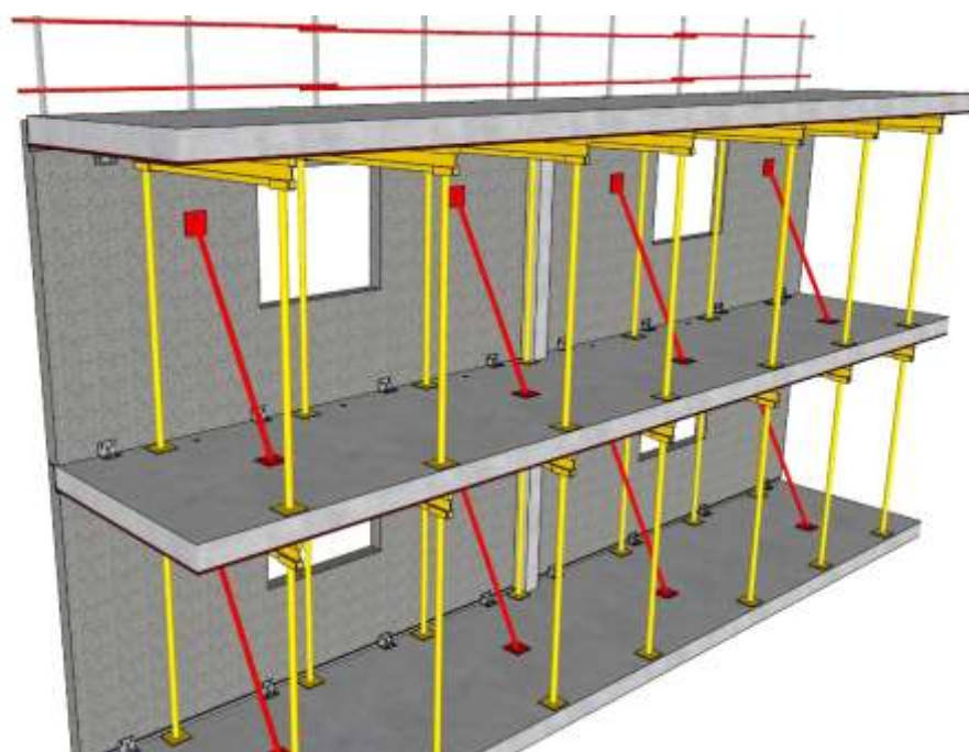
Figure 24 – Coulage de la dalle béton (FP3)
