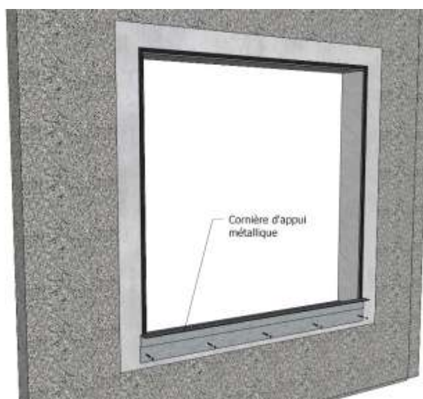
Figure 28 – Pose de la cornière d'appui
