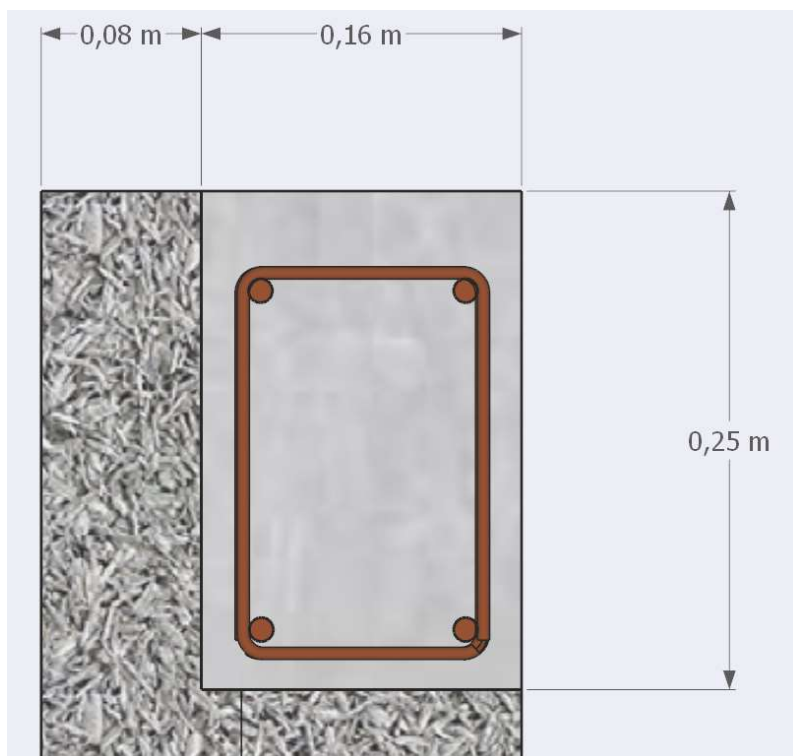
Figure A08 : Vue de principe en coupe d'un chaînage horizontal : Panneau de 24 cm d'épaisseur avec un plancher d'épaisseur 25 cm – chaînage régnant sur 2/3 de l'épaisseur du mur.
