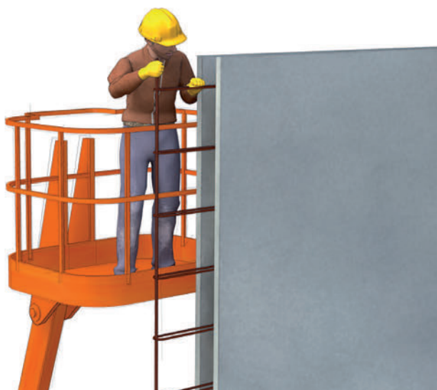
Figures 27 et 28. Mise en place des aciers de liaison
