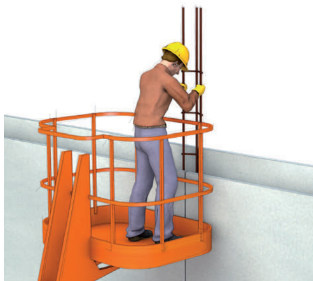
Figures 27 et 28. Mise en place des aciers de liaison
