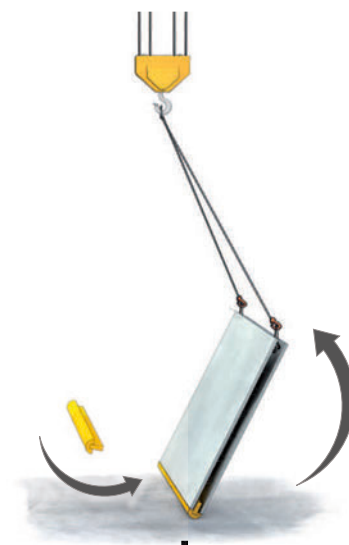
Figure 20. Relevage avec un sabot
