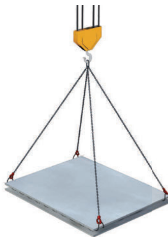
Figure 14. Élingage des petits éléments
