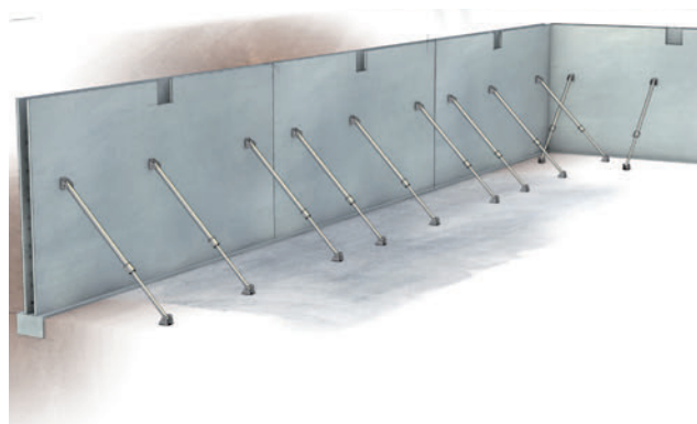
Figure 26. Stabilisation par étais tirants-poussants
