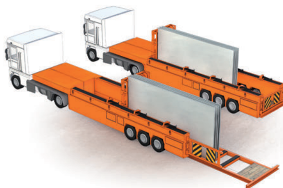
Figure 8. ETS de type 2 en position de transport/déchargement
