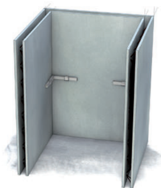
Figure 23. Exemple de gaine d'ascenseur
