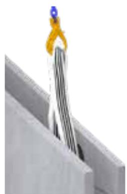
Le levage et le retournement se font systématiquement par 2 points (crochet jaune, crochet bleu ou cylindre + sangle).
