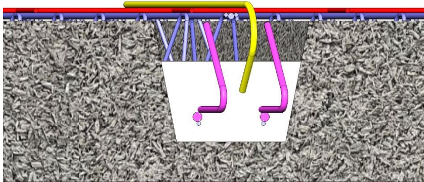
Figure 5-10 : Positionnement du treillis soudés dans la dalle de compression sur les treillis raidisseurs
